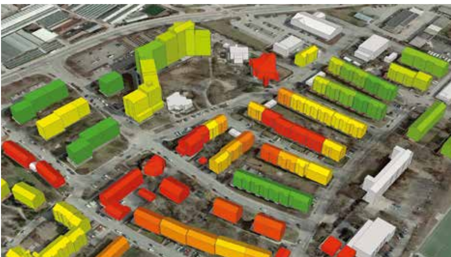
Projekt SimStadt: In Ludwigsburg wurde der Heizwärmebedarf von mehr als 14.000 Wohngebäuden berechnet.
