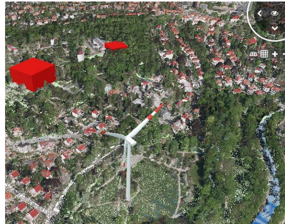
Abbildung 7: parametrisierte Darstellung via Klassifizierungsspalte (hier "wea_typ") sowie Rotationswert / Skalierungswert (hier "wea_rotat" / "wea_scale") Die Symbole sind entsprechend der Mapping-Regeln für die Werte "box" und "turbine" verschieden. Rotations- und Skalierungswert werden aus den Quelldaten benutzt.
