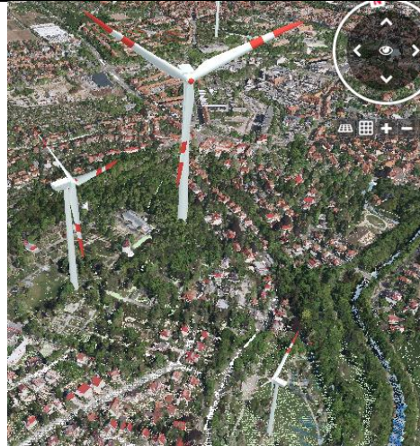
Abbildung 4: einheitliches Symbol mit parametrisierter Darstellung via Rotationswert / Skalierungswert (hier "wea_rotat" / "wea_scale") Die Symbole sind einheitlich sowie zusätzlich entsprechend der Quelldaten "gedreht" und in ihrer Größe verschieden.
